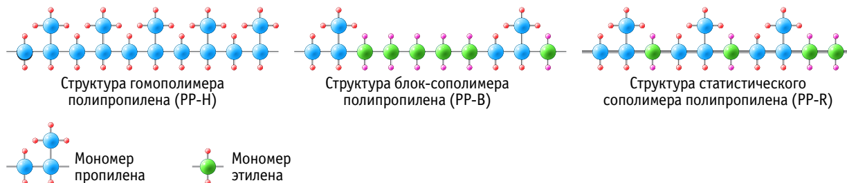
Рис. 1.44. Структура различных типов полипропилена (по молекулярной структуре)
