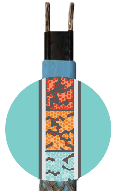
Рис. 3.95. Устройство саморегулирующегося электрокабеля
