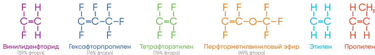
Рис. 1.48. Компоненты, входящие в состав фторэластомеров
