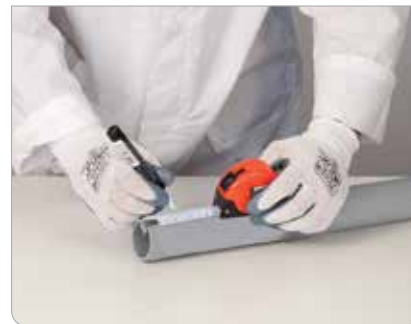
Рис. 3.16. Отметка глубины вставки на трубе
