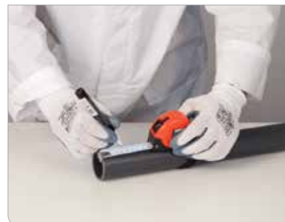
Рис. 3.6. Отметка глубины вставки на трубе
