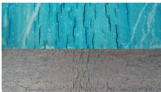
Рис. 2.2. Признаки химической деградации пластика из-за неверного выбора материала для перекачиваемой среды
