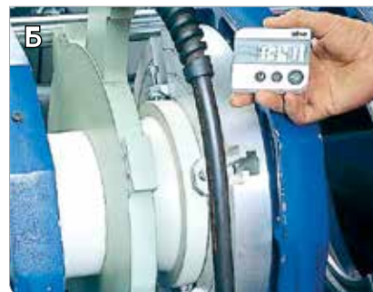
Рис. 3.32. Выравнивание с образованием грата
