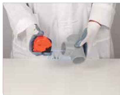
Рис. 3.15. Определение глубины раструба
