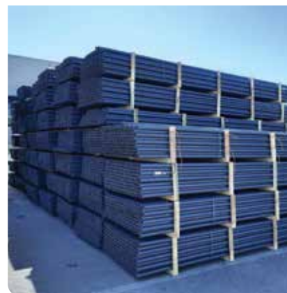
Рис. 3.111. Хранение труб на открытых площадках
