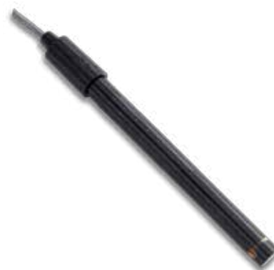
Рис. 2.90. Датчики с графитовыми и платиновыми электродами
