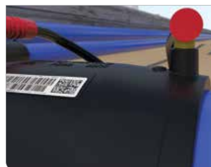
Рис. 3.46. Присоединение аппарата управления сваркой
