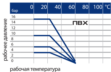
График соотношения температура/давление для воды и сред, нейтральных для ПВХ. Для других условий необходимо снизить номинальное давление
